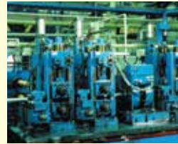
3 サイジング 溶接後の管に、種々の曲率のロールを用いて絞りを加え、管の外径寸法を整えます。丸管だけでなく、角管への成形も行います。
