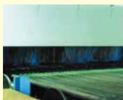
6 熱処理 高周波電気抵抗加熱溶接のままの管の金属組織を均一化・軟化するために、連続炉で熱処理します。
