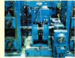
5 渦電流探傷 素材や溶接部の健全性を非破壊で検査します。
