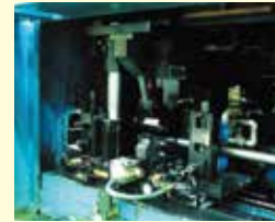
4 切断 連続造管している管を、刃物を用いて一定の長さに切断します。
