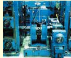
3 渦電流あるいは超音波探傷 素材や溶接部の健全性を非破壊で全数オンライン検査します。
