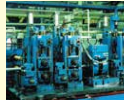
4 サイジング 溶接後の管に、種々の曲率のロールを用いて絞りを加え、管の外径寸法を整えます。丸管だけでなく、角管への成形も行います。
