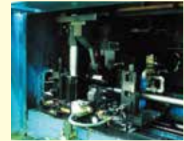
5 切断 連続造管している管を、刃物を用いて一定の長さに切断します。
