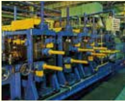
1 フォーミング 平板の帯鋼を種々の曲率のロールを用いて曲げ、管状に成形します。
