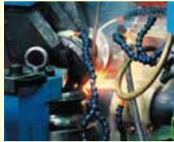
2 高周波電気抵抗溶接 管状に成形された帯鋼の縁部を、高周波誘導電流を利用して加熱溶融圧接を行います。
