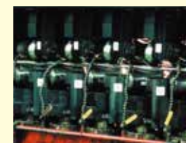
10 矯正 管の真直度を向上させます。
