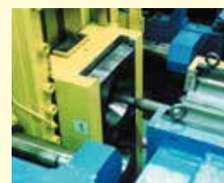
8 口付 冷間引抜加工を行うために管端をスウェッジ加工し、ダイスに挿入可能な外径にします。
